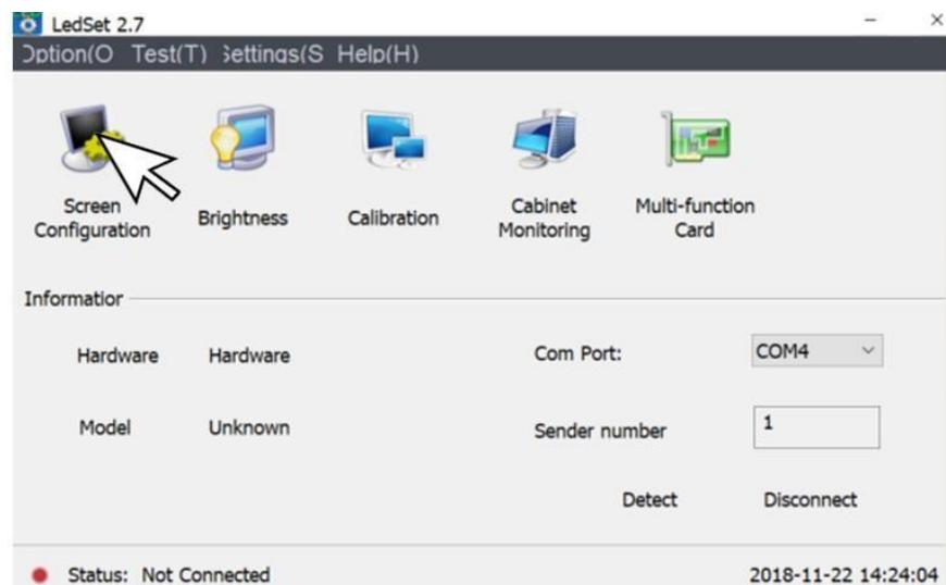
Seleccione **Screen Configuration** para configurar la pantalla (mapeo)
