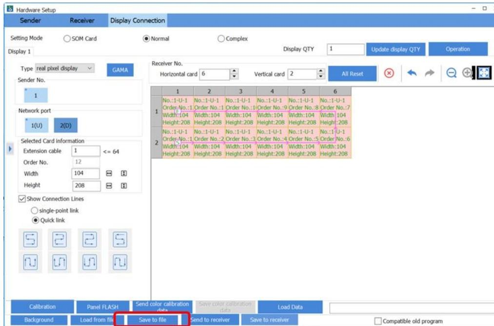
19. Cuando necesite cargar la configuración abra el archivo creado para la misma seleccionando "Load from file" y luego seleccione "Send to receiver" y "Save to receiver" para asegurar que la configuración quedará guardada en la pantalla.
