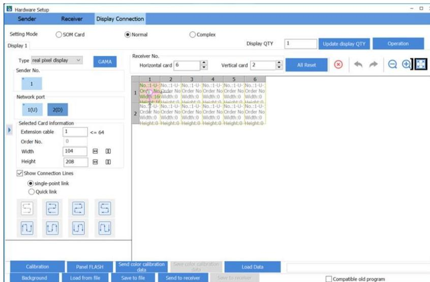
13. Configuramos los pixeles de cada módulo. Ancho (Width) y Alto (Height).
