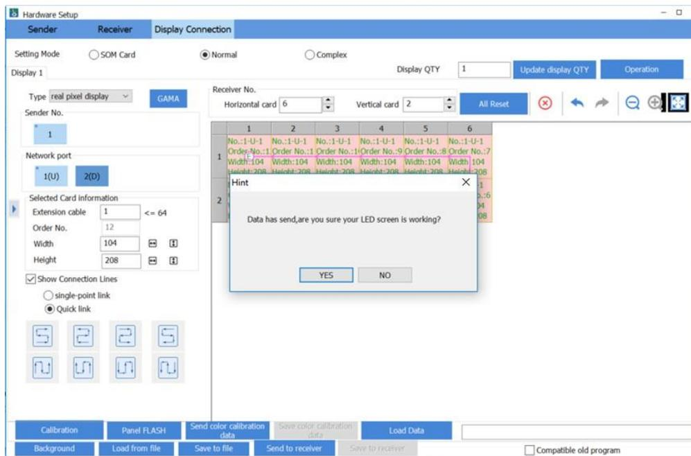
17. En este punto la pantalla estará funcionando en la configuración realizada mientras no se apague, pero cuando se vuelva a encender habrá perdido esta configuración, para que esto no ocurra seleccione "Save to receiver" y ya quedará guardada la configuración en cada módulo de la pantalla.
