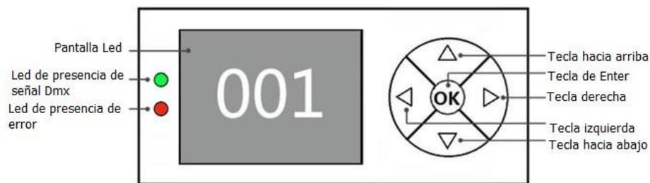
Figura 3 Diagrama esquemático de descripción de claves en el panel
