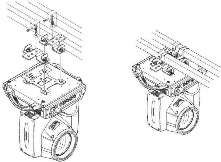
Figura 2 Diagrama esquemático de la lámpara colgada boca abajo.
