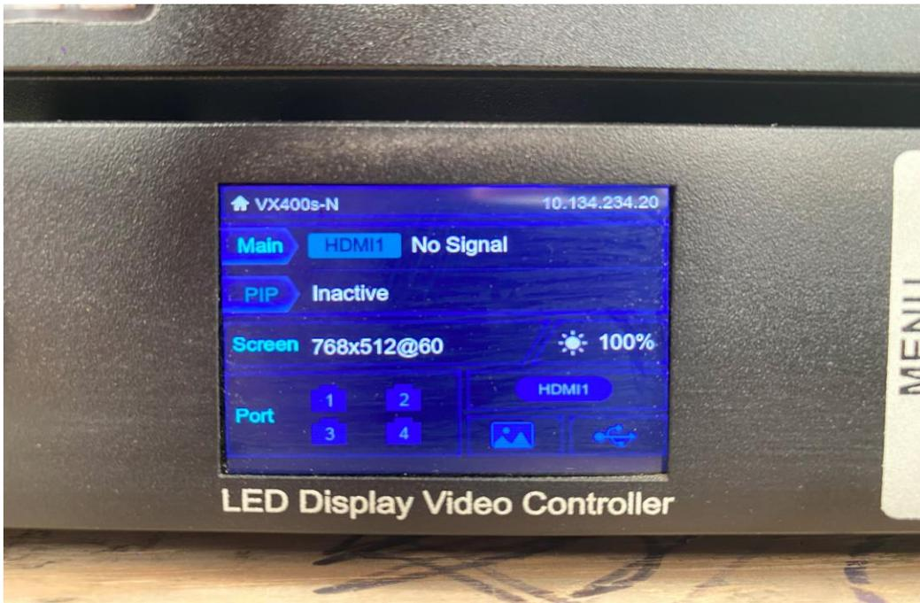
Video procesos de novastar de la serie VX automáticamente ajusta la resolución de la pantalla sin necesidad de ajustarlo manualmente.
