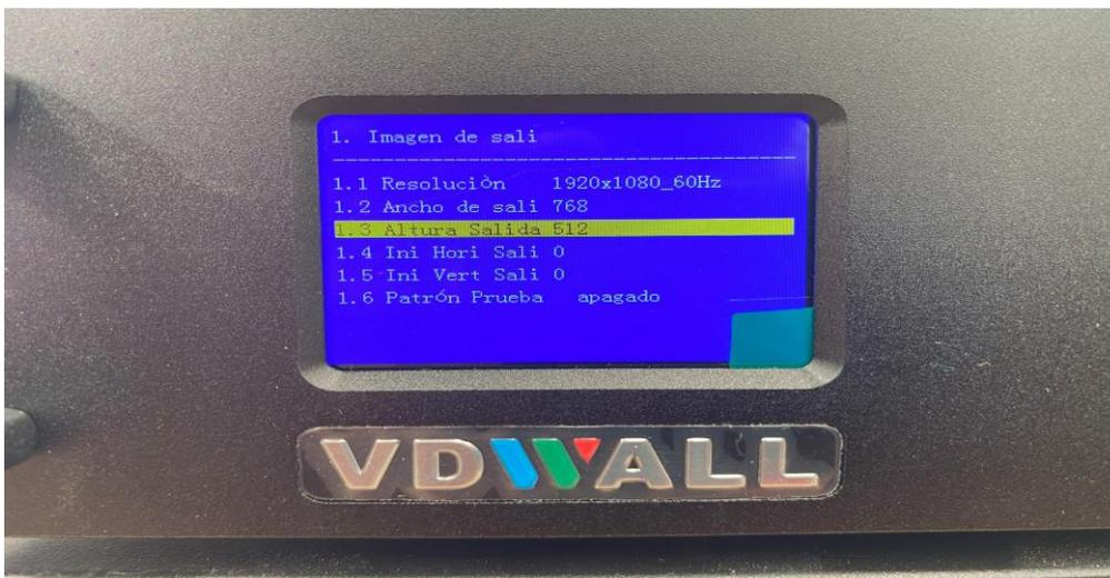
Video Procesos de marcas como VDWALL o de otras por lo general hay que ajustar la resolución manualmente la nomenclatura de ancho y alto puede cambiar dependiendo de la marca considerando **WIDH- ANCHO HEIGHT-ALTO**.
