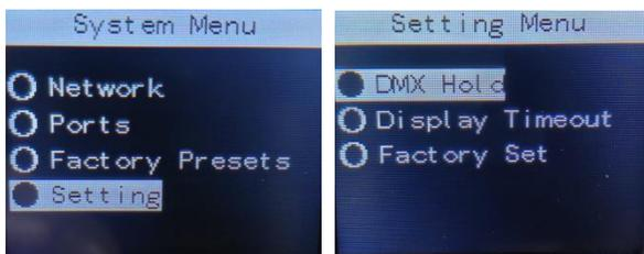
**4-2)** Presione la tecla ">", seleccione "DMX Hold", luego presione la tecla "Enter", elija el parámetro a modificar y presione la tecla "Enter" nuevamente para guardar y configurar el tiempo de espera DMX.
