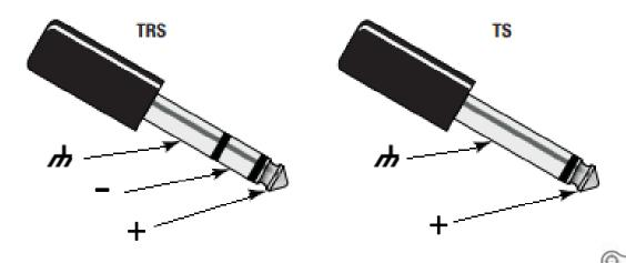
**Nota:** Los conectores combo de entrada aceptan conectores XLR Macho, conectores TS y TRS.
