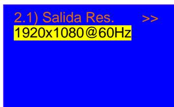
**VPX24** proporciona 1 puerto de salida DVI con 9 resoluciones de salida diferentes. En el menú principal, presione el botón **OK**, ingrese al menú 2.1) Salida Res., presione el botón **OK**, luego gire el botón **OK** para seleccionar la resolución de salida, la resolución de salida seleccionada debe ser mayor que la pantalla LED
