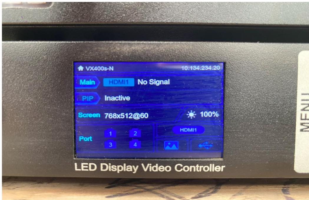
Video procesos de **NOVASTAR** de la serie VX automáticamente ajusta la resolución de la pantalla sin necesidad de ajustarlo manualmente.
