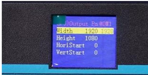
En nuestro video procesador **VPX 24** por lo general hay que ajustar la resolución manualmente la nomenclatura de ancho y alto puede cambiar dependiendo de la marca considerando **WIDH- ANCHO** **HEIGHT-ALTO**.
