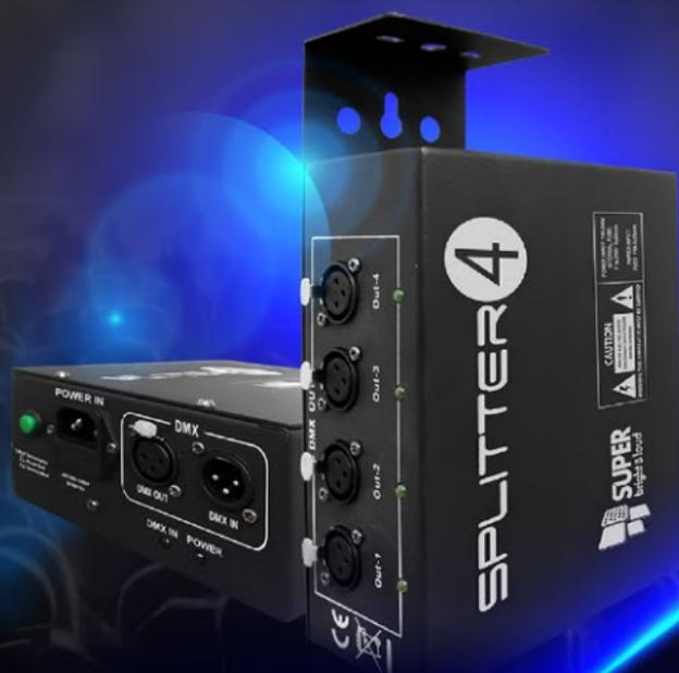
La amplificación permite extender la longitud de la línea más allá de la distancia específica en la norma estándar DMX-512. Si son necesarias más derivaciones, se pueden utilizar varios splitters (amplificadores-distribuidores) en la misma línea. Cada rama de la línea deberá ser tratada como una línea independiente con hasta 32 unidades, cada una de ellas debe tener un terminador al final de ella. Construcción robusta para un funcionamiento sin problemas.
